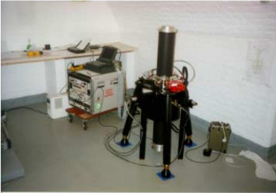
**Gravimètre absolu FG5 modèle 206 (Micro-g Solutions Inc.) en opération au site de Strasbourg**
