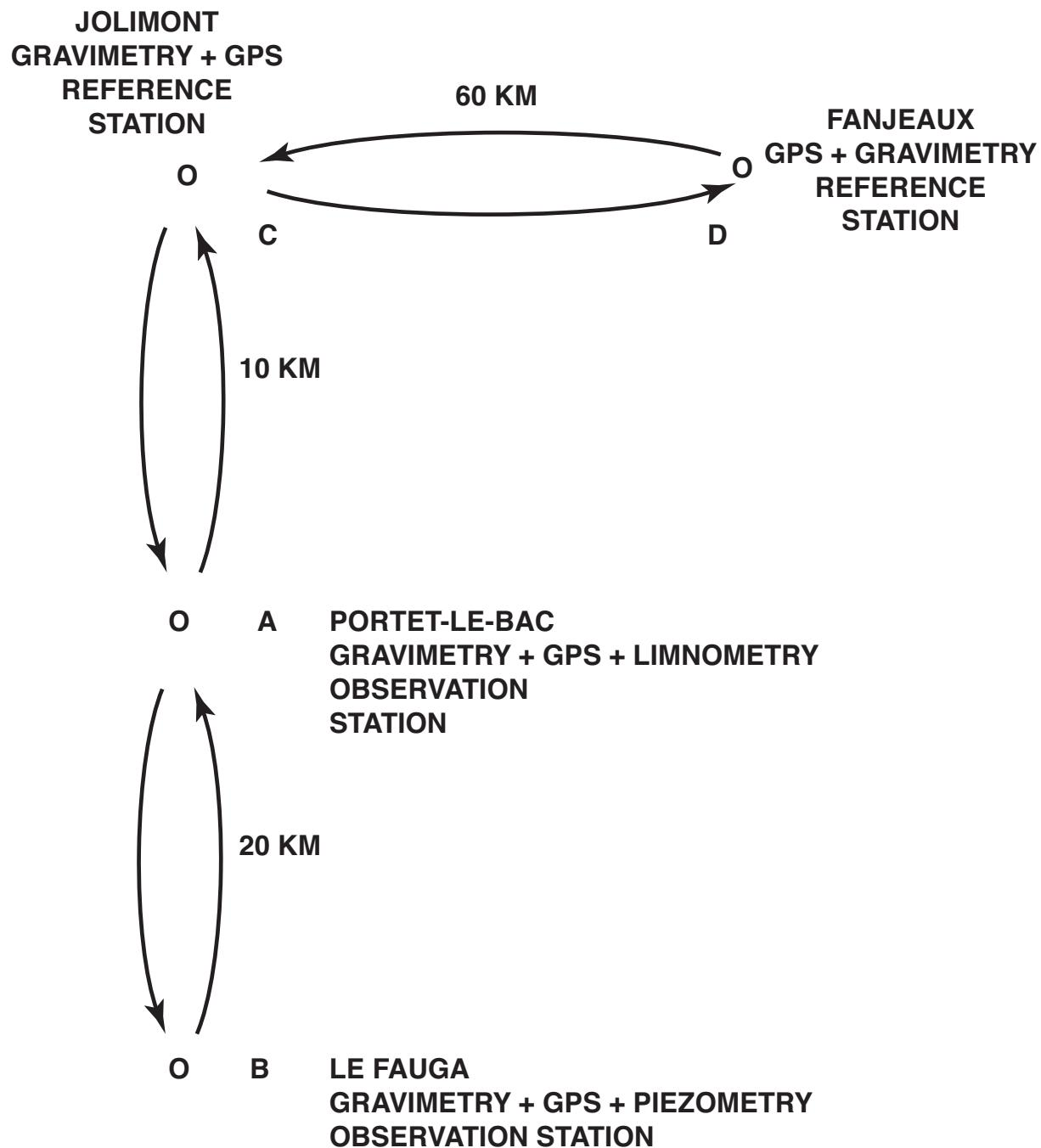
**FIG. 10 : GRAVIMETRY/GPS OBSERVATION LOOP**
